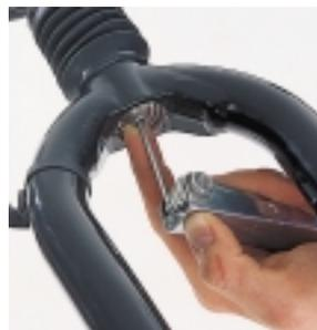
▶ **3** Bevor Sie die **GABEL ÖFFNEN**, lassen Sie einer gasgefüllten Fatty unbedingt die **LUFT RAUS**. Bei einem Stahlfedermodell (kein Luftventil am unteren Ende des Schaftrohrs) reduzieren Sie mit einem 3-mm-Inbus die Federvorspannung durch die zentrale Bohrung von oben auf das Minimum. Dann lösen Sie den Deckel der Gabel
