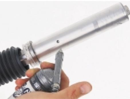
► **6** Ist alles picobello, starten Sie den **ZUSAMMENBAU** mit einer kleinen **SCHMIERORGIE**. Verwenden Sie ein gutes Fett, wie z. B. Finish Line Teflon Grease. Schmieren Sie die äußeren Laufbahnen von oben, die inneren von unten, und versorgen Sie die Nadelrollen durch die Bohrung im äußeren Rohr mit einer Fettpresse. Bewegen Sie das Linearlager anschließend ausgiebig, damit sich das Fett gut verteilt. Dann kommt
