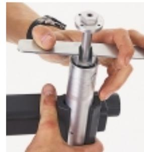
mit einem verstellbaren Stiftschlüssel im Gegenuhrzeigersinn. Komprimieren Sie die Gabel vollständig. Nun kommt das Gehäuse des Dämpfers zum Vorschein, den Sie nur mit dem speziellen Cannondale-Pin-Tool (Foto ganz rechts) ausbauen sollten. Halten Sie die Gabel maximal eingefedert, und drehen Sie auch hier im Gegenuhrzeigersinn.
